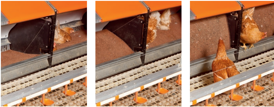
Zur Nacht verschließt der Kippboden automatisch das Nest – brütige Hennen müssen das Nest verlassen
