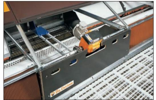
Die Antriebseinheit zum Verschließen/Öffnen der Nester besteht aus Getriebemotor und Winde. Sie befindet sich je nach Länge der Nestlinie mittig oder am Anfang jeder Linie und weist eine hohe Funktionssicherheit auf.
