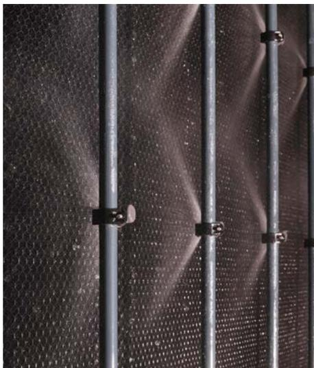
Hochwertige Kunststoffpads werden mit Wasser besprüht → kein Anhaften des Staubes
