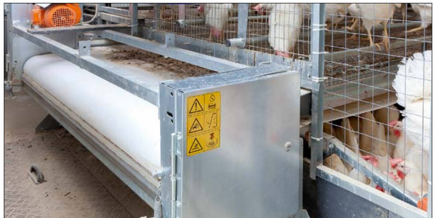
Kotband unter der Versorgungszone der einetagigen Natura-Nova
