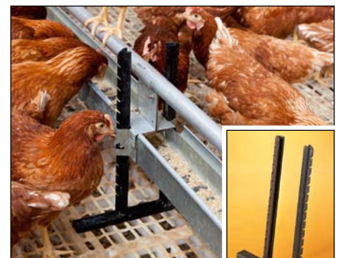
Kunststoffständer je nach Kotgrube auch mit 4 und 8° Neigung
