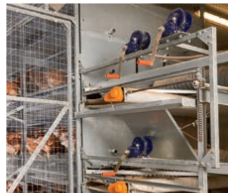
Handwinde pro Etage: gleichzeitiges, einfaches Öffnen der Vordergitter
