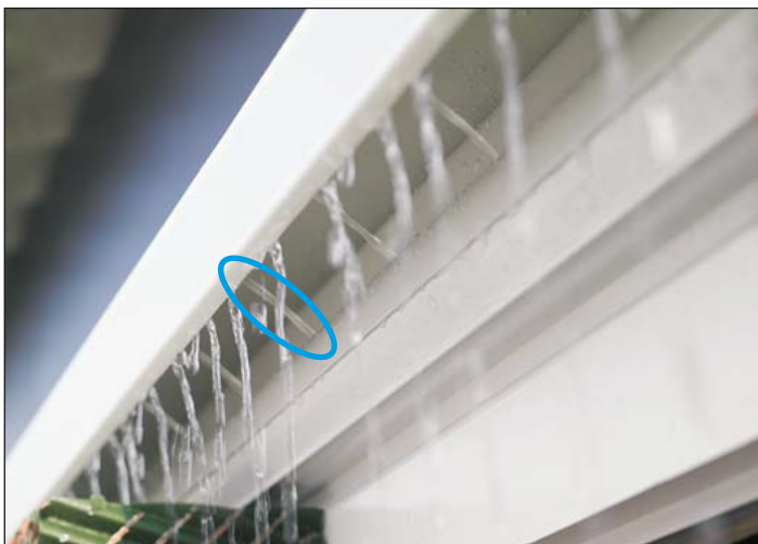
Top-Profil mit gelochtem Rohr und Deflektor zur gleichmäßigen Wasserverteilung auf die Pads
