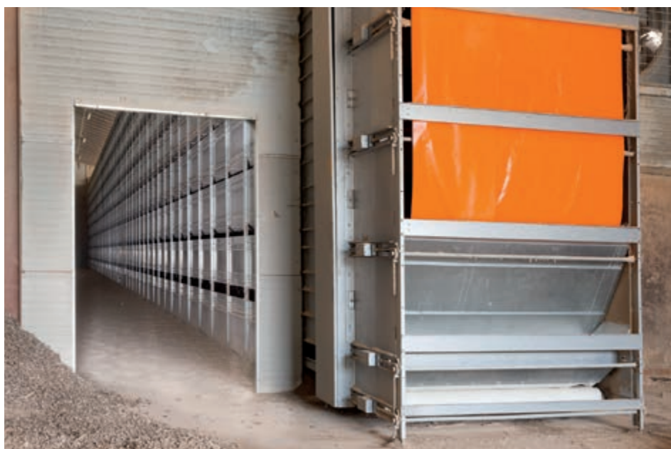
Kottrocknungstunnel OptiSec mit 16 Etagen
