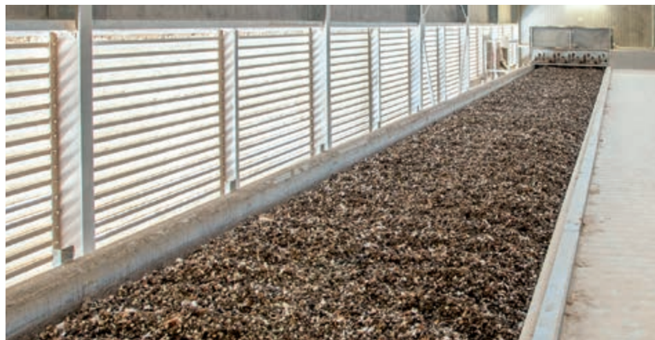
Blick auf die oberste Etage, am Ende befindet sich ein Kotrechen, der die Struktur des Kotes auflockert
