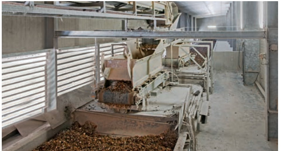
Befüllstation: Hier stehen 2 OptiPlate Kopf an Kopf und werden von einem Förderband befüllt
