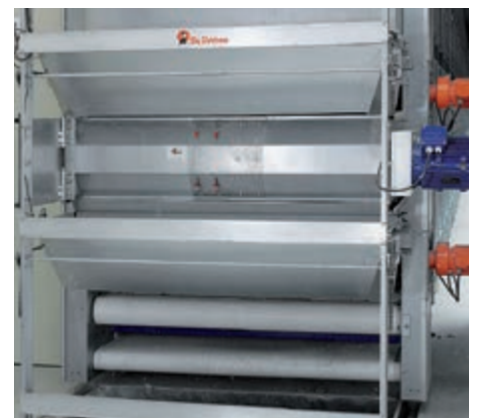
Der Häcksler ist hier zwischen der 3. und 4. Etage montiert
