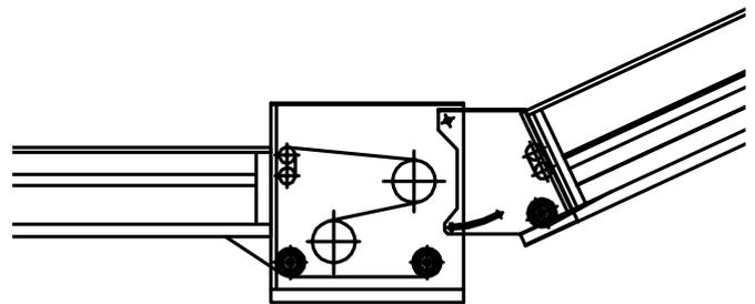
Zwangsumlenkung mit Gittertrommel
